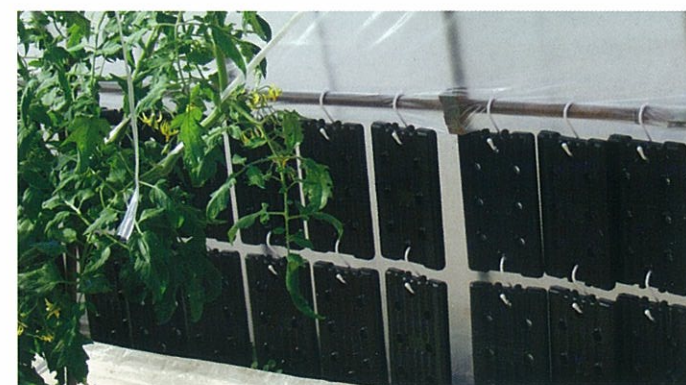
2段配列されたエネバンク
